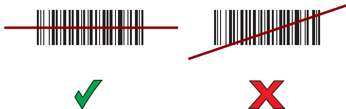
Figura 30 Patrón de enfoque del lector láser
