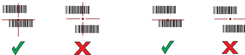
Figura 29 Modo de lista de selección con varios códigos de barras en un patrón de enfoque: rango estándar y ampliado
